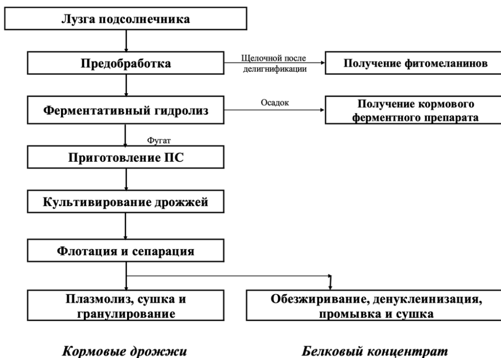
Рисунок 6 – Технологическая блок-схема переработки подсолнечной лузги
