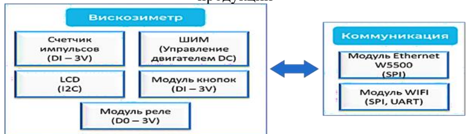
. Структура вискозиметра с коммуникационными модулями
