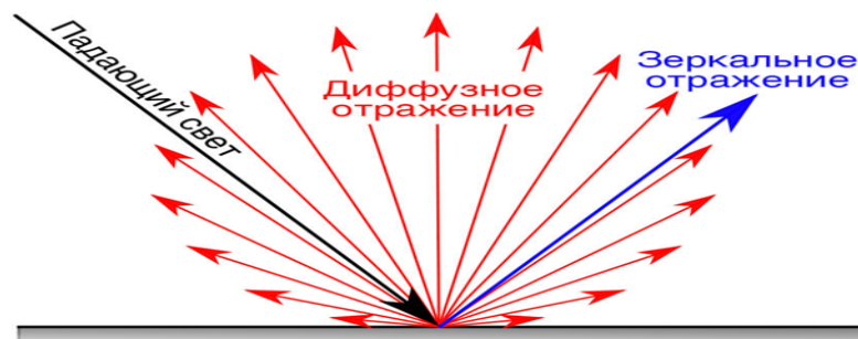
Рис. 3.23. Оптическая характеристика свойства поверхности, отражающей свет
