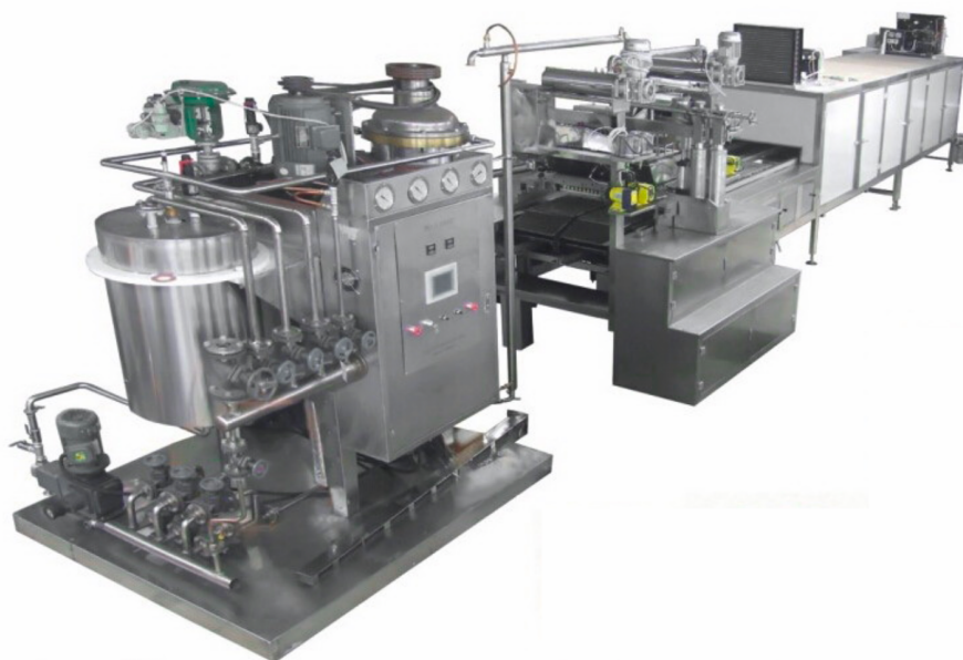
Рис. 1.22. Производственная линия приготовления мармелада в 3D виде
