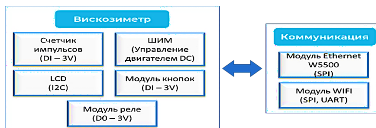
Рисунок 3.71. Структура вискозиметра с коммуникационными модулями
