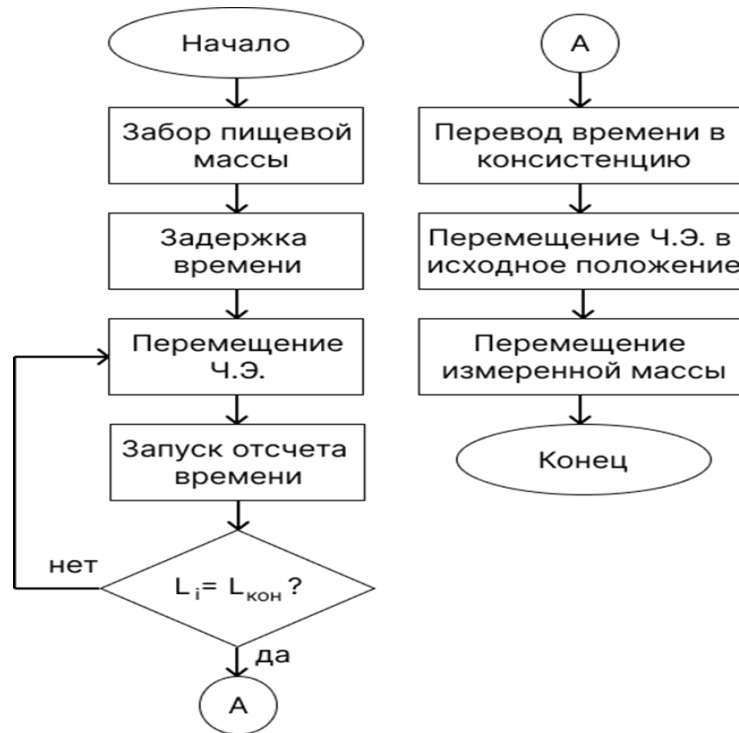
Рис. 3.38. Алгоритм работы цифрового консистометра
