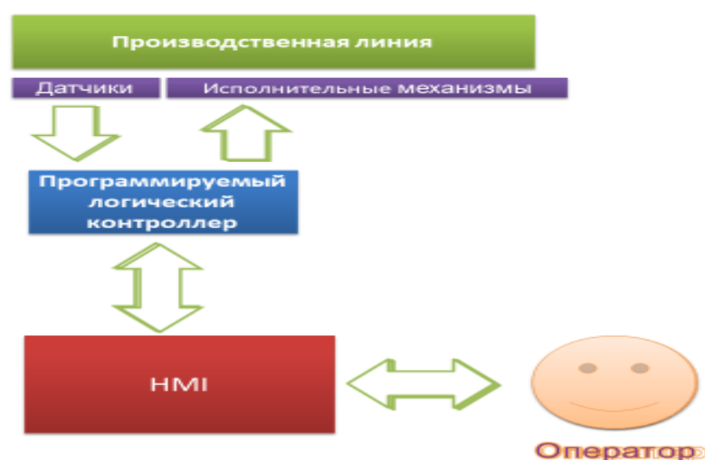
Рис. 3.1. Система управления на базе промышленного логического контроллера
