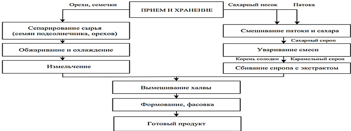
Рис. 1.17. Основные стадии процесса производства халвы
