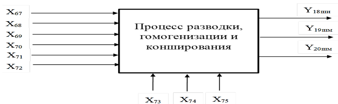
Рис. 4.33. СПМ ТП разводки, гомогенизации и конширования
