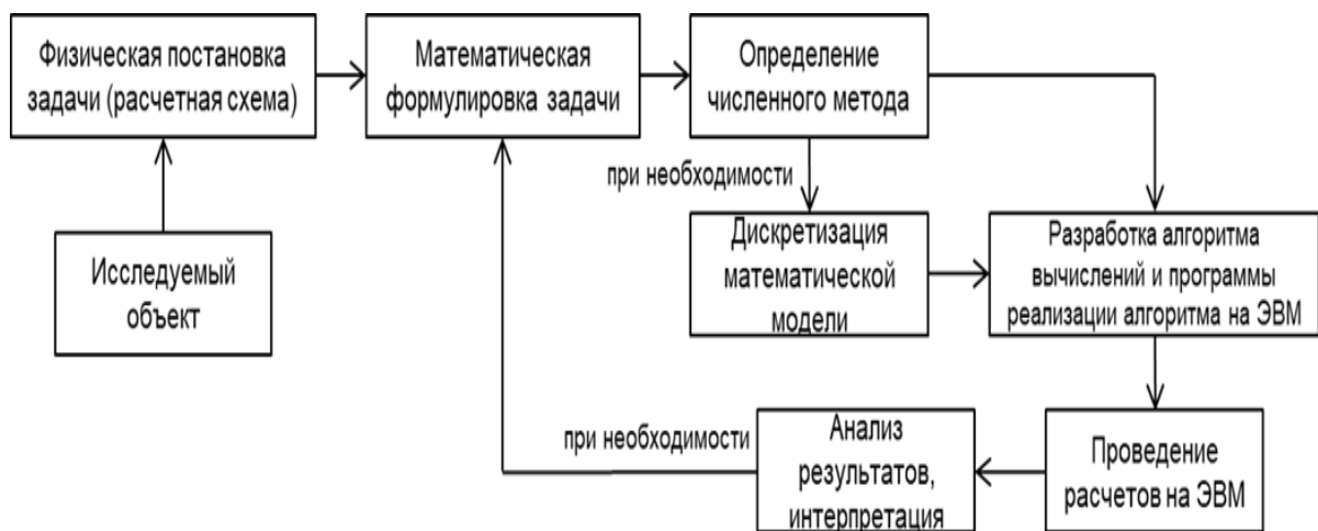
Рис. 5.6. Этапы создания математической модели на ЭВМ
