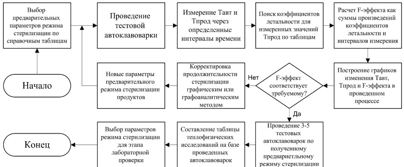
Рисунок 3.1 – Алгоритм проведения этапа предварительного подбора нового режима стерилизации
