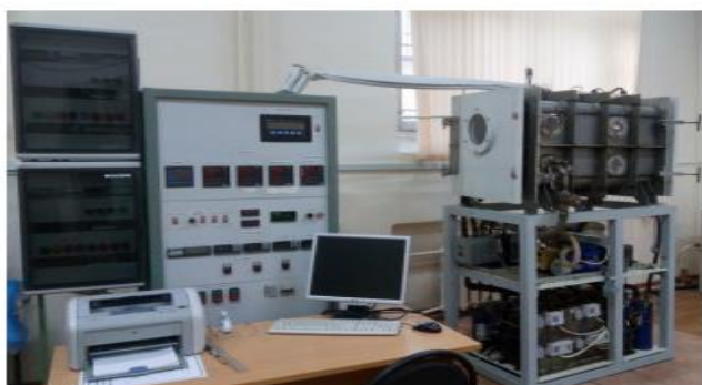
Рисунок 52 – Лабораторный комплекс СВП-0,36 (слева) и принципиальная схема сублимации, где 1 - тензвесы; 2 - нагревательные элементы; 3 - противни с продуктом; 4 - сублимационная камера; 5 - конденсатор; 6 - десублиматор; 7 - вакуумные насосы; 8 - холодильные машины
