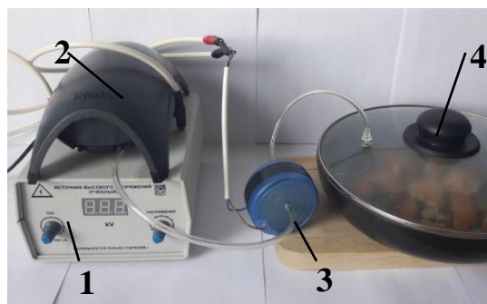
Рисунок 61 – Установка для ЭСО продукции общественного питания, где 1 - источник высокого напряжения; 2 - компрессор; 3 - блок ЭСО; 4 - образец блюда в сковороде с крышкой с клапаном
