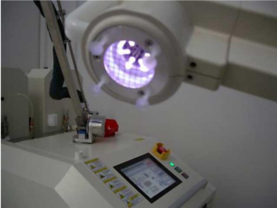
Рисунок 12 – Генератор низкотемпературной аргонной плазмы
