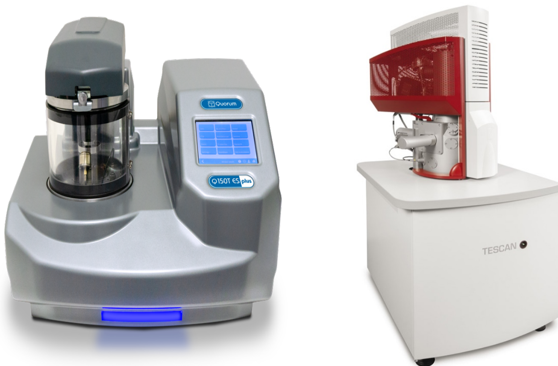
Рис. 6. Сканирующая электронная микроскопия: а – настольная напылительная установка «Q150T ES» («Quorum Technologies», Великобритания); б – сканирующий электронный микроскоп «Mira3 LM» («TESCAN Brno», Республика Чехия)
