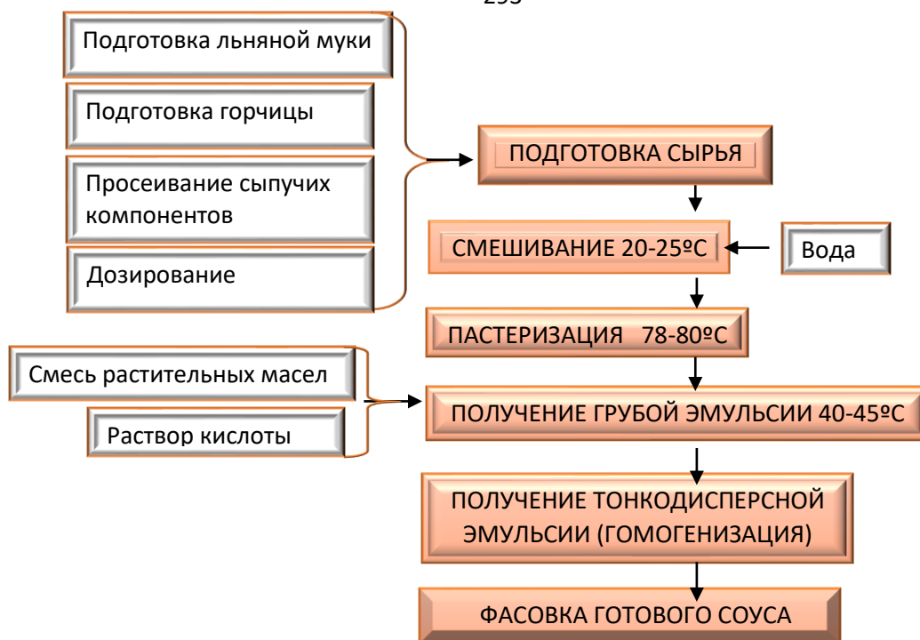
Рисунок 7.29 – Технологическая схема получения эмульсионных соусов с использованием льняной муки
