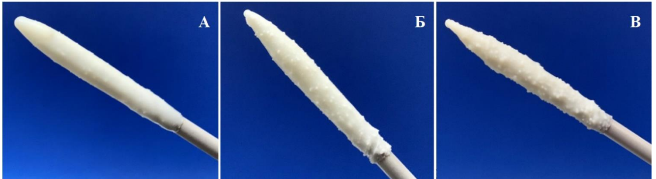
Рисунок 3.45 – Визуализация потери текучести исследуемых образцов моделей аналогов сгущенного молока с сахаром при хранении в течение 54 минут: А – при минус 30 °С, Б – при минус 32,5 °С, В – при минус 35 °С
