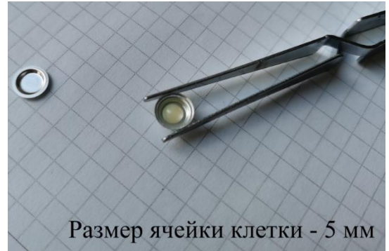
Рисунок 2.14 – Образец сгущенного молока с сахаром в тигле перед закрытием крышкой и запрессовкой
