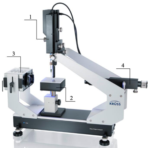
Рисунок 2.19 – Анализатор формы капли DSA25, где 1 - дозирующий модуль, 2 - столик для образца, 3 - видеосистема, 4 - источник света
