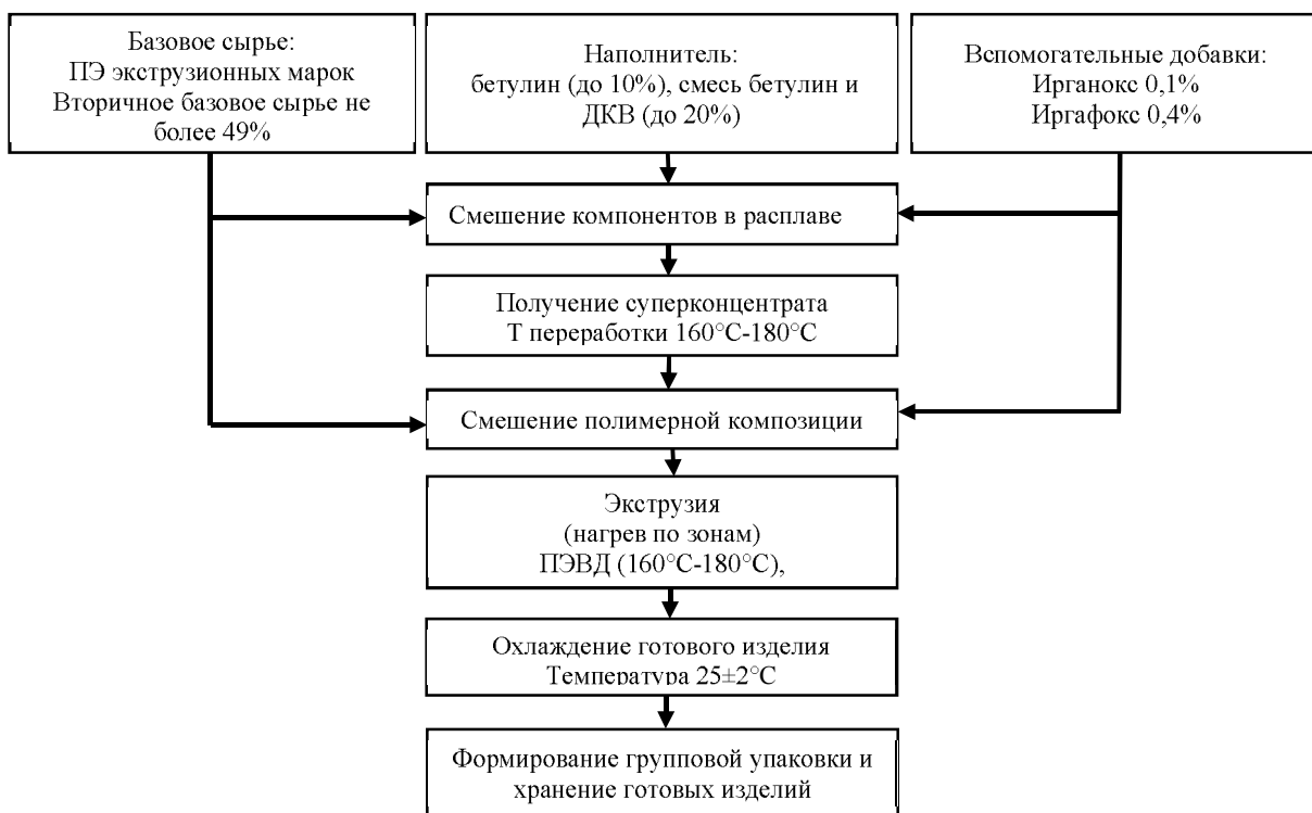
Рисунок 7.4 – Алгоритм получения полиэтиленовой выдувной тары, модифицированной органическими компонентами
