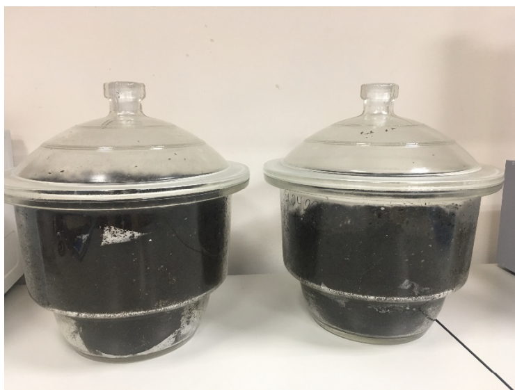
Рисунок 2.5 – Опытные образцы биоразлагаемой пленки, помещённые в КОМПОСТ
