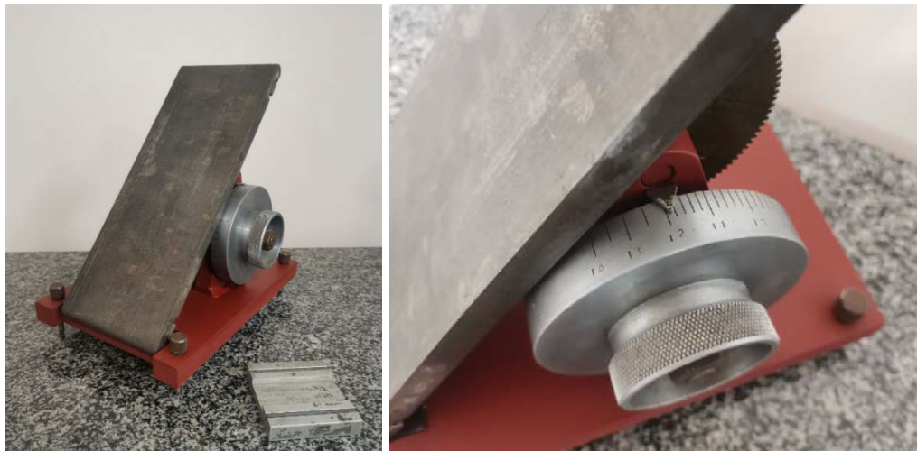
Рисунок 2.4 – Оборудование для определения коэффициента трения статического
