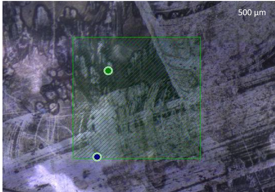
Рисунок 3.8 – Поверхность опытного образца со стороны непосредственно контактирующей с продуктом, с содержанием модифицирующей добавки 1%.
