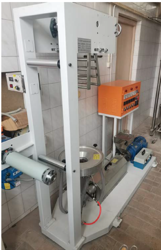
Рисунок 2.2 – Внешний вид и технические характеристики лабораторного экструдера SJ-28
