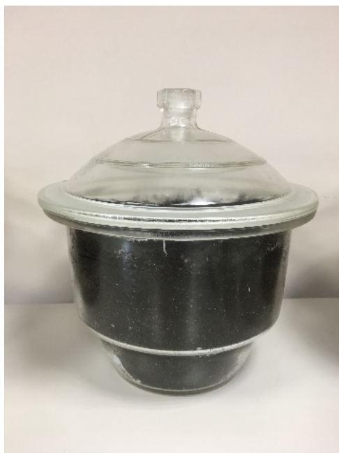
Рисунок 3.15 – Образцы полимерной высоконаполненной пленки, помещённые в компост
