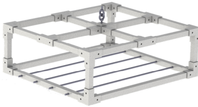
Рисунок 2.29—Чаша для подвешивания продукта
